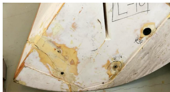
图1 蛟龙号浮力材料损伤 [2]
